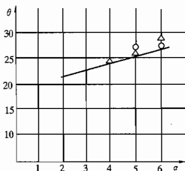
图 7 双层地基试验 \alpha - \theta 曲线
